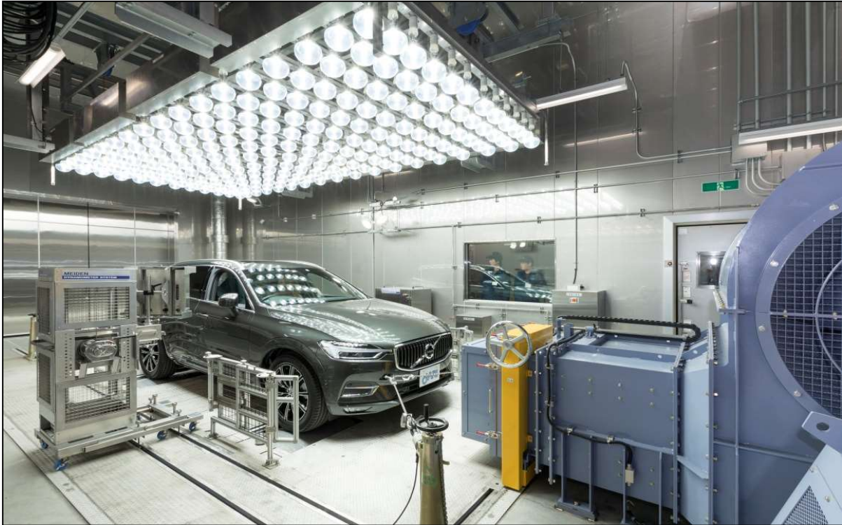
環境型 小型車用シャシダイナモメータ (4WD、日射装置付)
